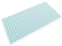
Termoizolacione ploče od ekspandiranog polistirena namjenjene za ugradnju u zonama objekta u kojima se očekuju pritisna opterećenja na fasadni dio, kao i pojačano prisustvo vlage (sokl, perimetrijski tj. podrumski zidovi). Dimenzije ploča: 1200 x 600, debeline 20-150 mm
