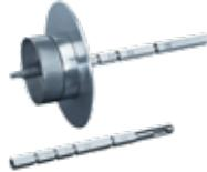
Specijalni alat za montažu STR pričvrsnice u izolacione ploče od EPS i mineralne vune. Izmjenjive rezne ivice i vjici omogućavaju montažu u ravnini sa površinom kao i utisnutu montažu (za sve vrste primjene). Montaža u ravnini sa površinom se izvodi sa podešivnom pločom.
