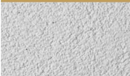
Jedinstvena formulacija jamči visoku učinkovitost na području potrošnje i iskoristivosti, ovisno o strukturi i veličini zrna. Zaribane strukture sa zrnom veličine maksimalno 2,0 mm imaju potrošnju od 2,9 kg/m<sup>2</sup>, dok strukture s veličinom zrna od 1,5 mm troše 2,5 kg/ m<sup>2</sup> a za zrna od 3,0 mm potrebno je 3,9 kg/ m<sup>2</sup>. Žljebaste strukture imaju potrošnju od 2,6 kg/m<sup>2</sup> za zrna od 2,0 mm i 3,6 kg/m<sup>2</sup> za zrna od 3,0 mm.
