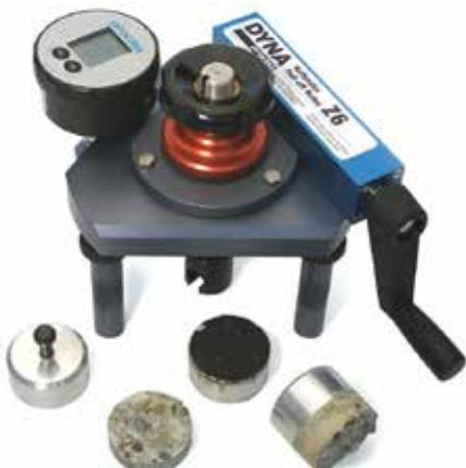
Ispitivanje čvrstoće podloge Pull-Off
