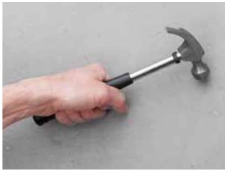
Stanje podlage možemo procijeniti na jednostavan način, lupkanjem čekićem.
