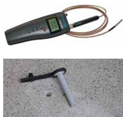
Mjerač vlage s vanjskom sondom
