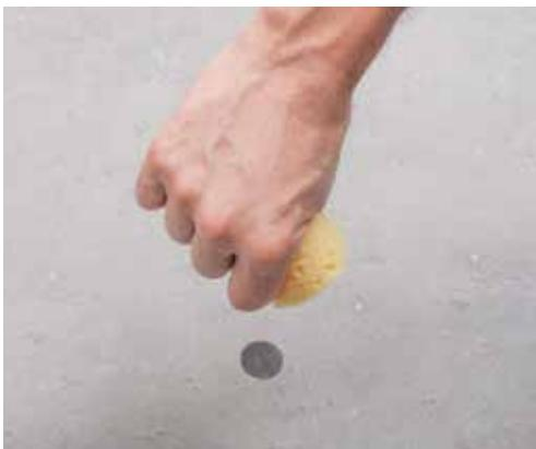
Jednostavni test upojnosti podloge
