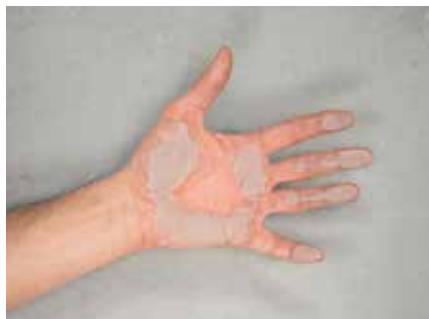
Stanje podloge može se procijeniti trljanjem podloge dlanom
