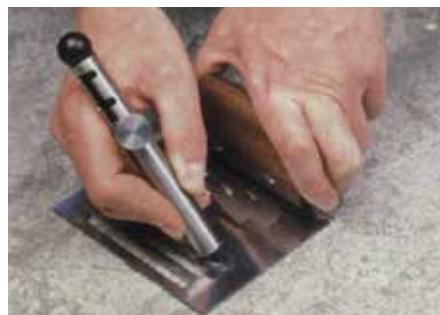
Ispitivanje podloge primjenom ispitivača
